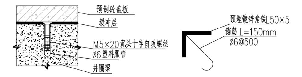
橡胶缓冲层安装大样图
