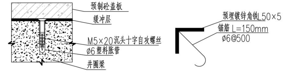
橡胶缓冲层安装大样图
